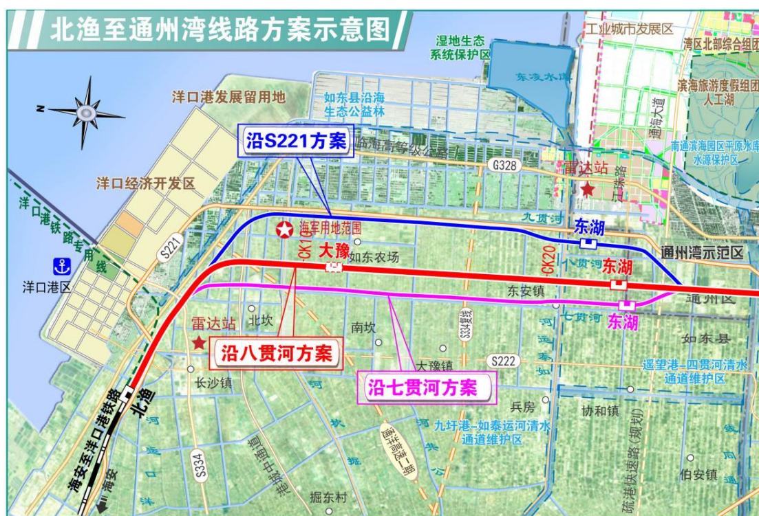
图 4.2-1 北渔至东湖段线路方案比选示意图
