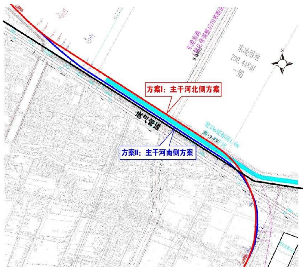
图 4.2-5 并行南-主干河段线路局部方案比选示意图
